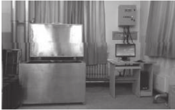
图 2 利用快速冻融试验机进行冻融循环试验
