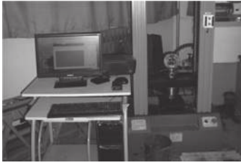
图 1 利用万能试验机预加初始损伤
